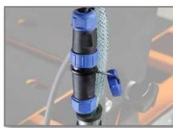
Acoplamiento rápido de la bomba de agua.
