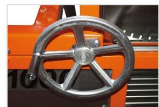
Movimiento del cabezal de corte mediante volante
