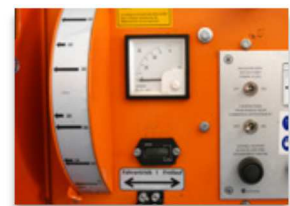
Accionamiento electrohidráulico. La máquina se puede mover sin que el disco se ponga en funcionamiento.
